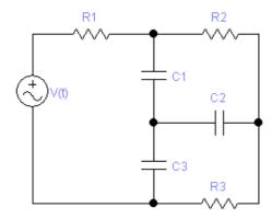
Eligiendo las corrientes sobre  $R_1$ ,  $R_2$  y  $C_2$  hacia la derecha, la de  $R_3$  hacia la izquierda, y sobre  $C_1$ ,  $C_3$ hacia abajo, los voltajes en los capacitores verifican el sistema
