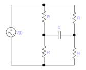
Lo veremos con las fórmulas. Como hay un solo acumulador de energía el sistema es de orden 1. Sean  $i_1$ ,  $i_2$  las corrientes en las resistencias superiores, orientadas hacia abajo y  $v_C$  el potencial en el capacitor. La corriente en el capacitor  $i_C$ , orientada hacia la derecha, verifica:  $i_1 + i_C = i_2$  y  $C v_C' = i_C$ .
