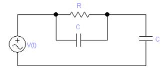
Los potenciales en los capacitores  $v_1$  y  $v_2$  verifican  $R C_1 v_1' - R C_2 v_2' = v_2$ ,  $v_1 + v_2 = V(t)$ Eliminando  $v_2$  obtenemos la ecuación que satisface  $v_1$ :
