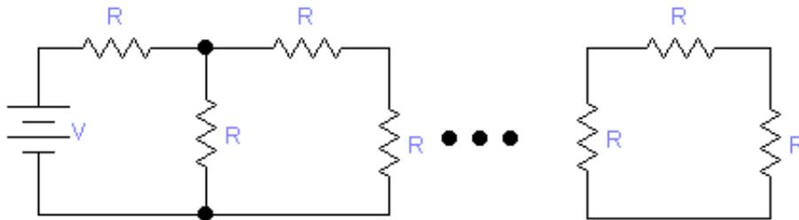
Si  $i_k$  es la corriente en la  $k$  - ésima resistencia horizontal entonces  $R i_k + R(i_k - i_{k+1}) = R(i_{k-1} - i_k)$
