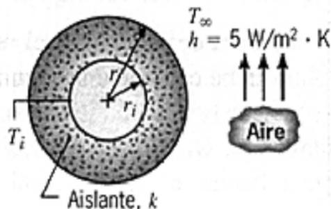
Sustancia refrigerante, transportada en un tubo de cobre a una temperatura  $T_i$  menor que la del aire ambiente,  $T_\infty$ . Si se aplica aislación al tubo, hallar el espesor óptimo.
